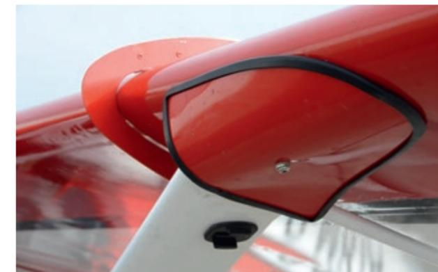
**Konsequent** Die Streben sind unten am Rumpf und an beiden Flügelbefestigungspunkten (im Bild der vordere) verkleidet, um den Luftwiderstand zu senken. Gut aussehen tut es obendrein
