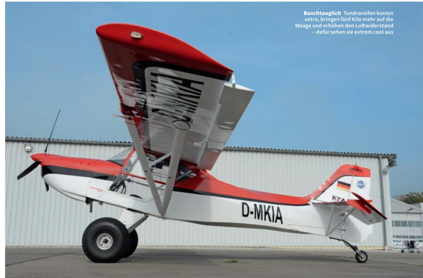
**Buschtauglich** Tundrareifen kosten extra, bringen fünf Kilo mehr auf die Waage und erhöhen den Luftwiderstand – dafür sehen sie extrem cool aus
