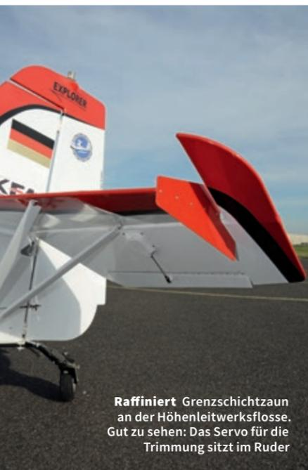
Raffiniert Grenzschichtzaun an der Höhenleitwerksflosse. Gut zu sehen: Das Servo für die Trimmung sitzt im Ruder
